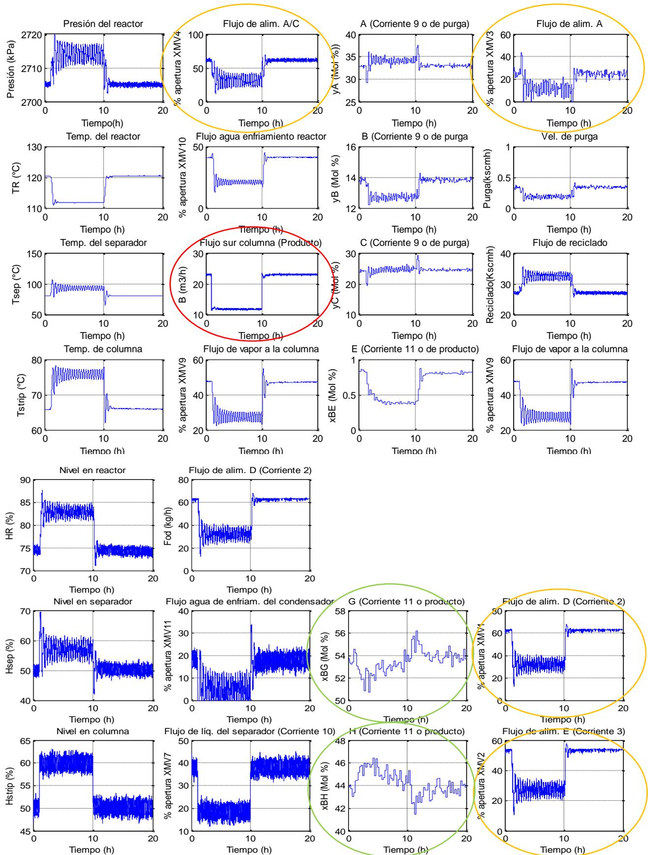
Figura 6-6 Respuesta dinámica al cambio del 50% en el flujo de producto (Lab. Virtual de Procesos)
